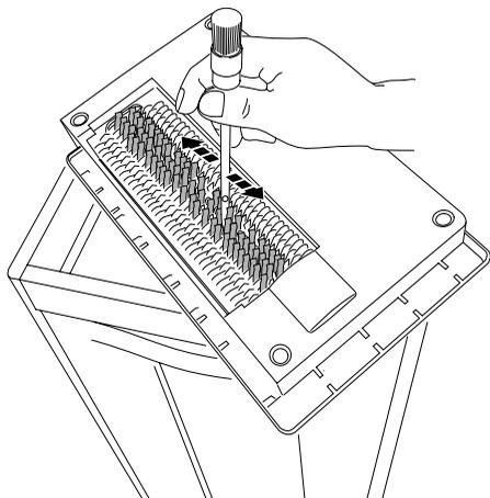
**RUS** Периодически очищайте режущий механизм аппарата.
